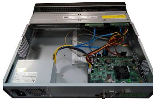
3 Conecte el cable de datos de HDD a la tarjeta principal y el puerto HDD respectivamente. Afloje el cable de alimentación del chasis y conecte el otro extremo del cable de alimentación al puerto de HDD.
