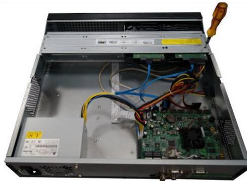
2 Coloque el disco duro en el soporte de disco duro en el chasis y luego alinear los cuatro tornillos de los cuatro agujeros en el disco duro. Utilice el destornillador para fijar firmemente los tornillos para fijar HDD en el soporte de HDD.
