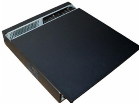
4 Después de conectar el cable, ponga la tapa frontal de nuevo al dispositivo y luego fijar los tornillos del panel trasero.
