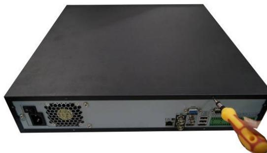
1 Utilice el destornillador para soltar los tornillos de la parte posterior y luego retire la cubierta frontal.
